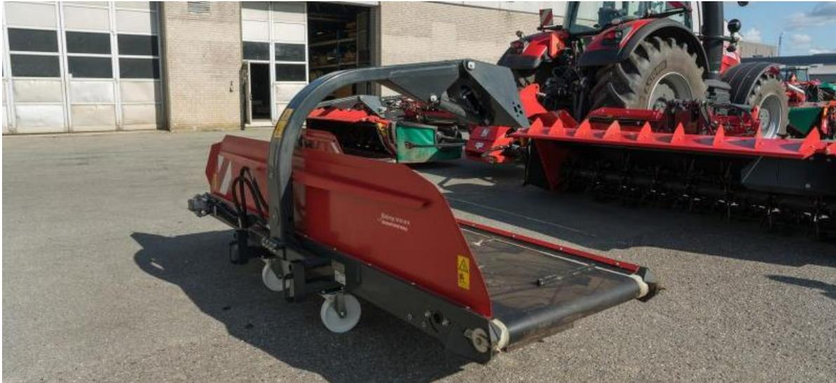
**Kverneland présente une nouvelle solution de démontage rapide pour les tapis montés sur ses combinaisons de faucheuses conditionneuses, éliminant ainsi l'excès de poids et réduisant les coûts de fonctionnement.**
