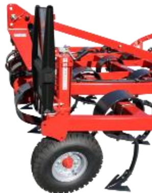
Les roues de jauge assurent le contrôle de la profondeur de travail
