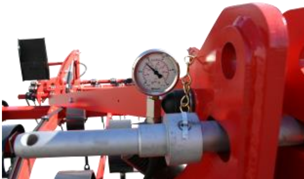
Réglage de la pression de la herse hydraulique avec un manomètre sur la tête d'attelage
