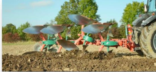
Ces âges robustes sont forgés pour limiter la présence de soudures qui pourraient être des points faibles. Comme sur l'ensemble des charrues à sécurité Non-Stop, les âges sont creux pour optimiser le poids de la charrue et l'effort de traction requis, et donc la consommation de carburant.
