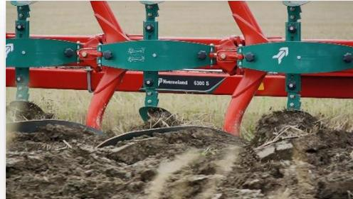
Ces ages robustes sont forgés afin d'éviter la présence de soudures qui pourraient fragiliser ces éléments. Comme toutes les charrues à sécurité Non-Stop Kverneland, ces ages sont creux afin d'optimiser le poids de la charrue, ce qui permet de limiter l'effort de traction nécessaire et la consommation de carburant.
