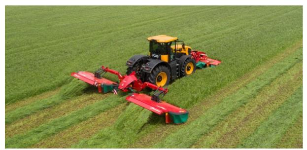
La fonction GEOMOW Kverneland optimise le chevauchement entre les faucheuses avant et arrière, pour utiliser la largeur de fauche maximale.
