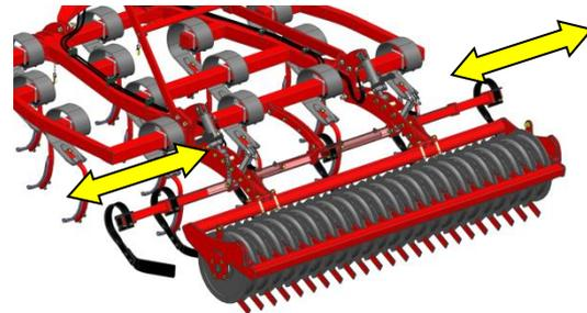
*Repliage hydraulique position travail / transport*
