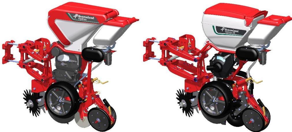
Optima HD II et Optima SX équipé du nouveau micro granulateur électrique
