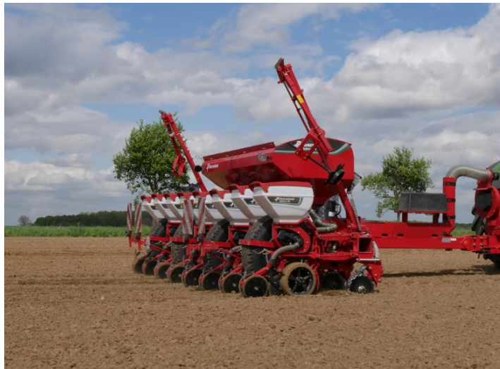
Optima TF profi équipé du nouvel élément semeur SX “High Speed”
